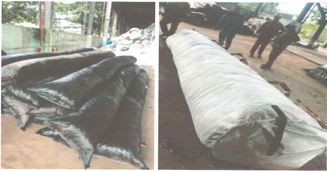
Hình 8. Chế tạo phao nổi giảm sóng
