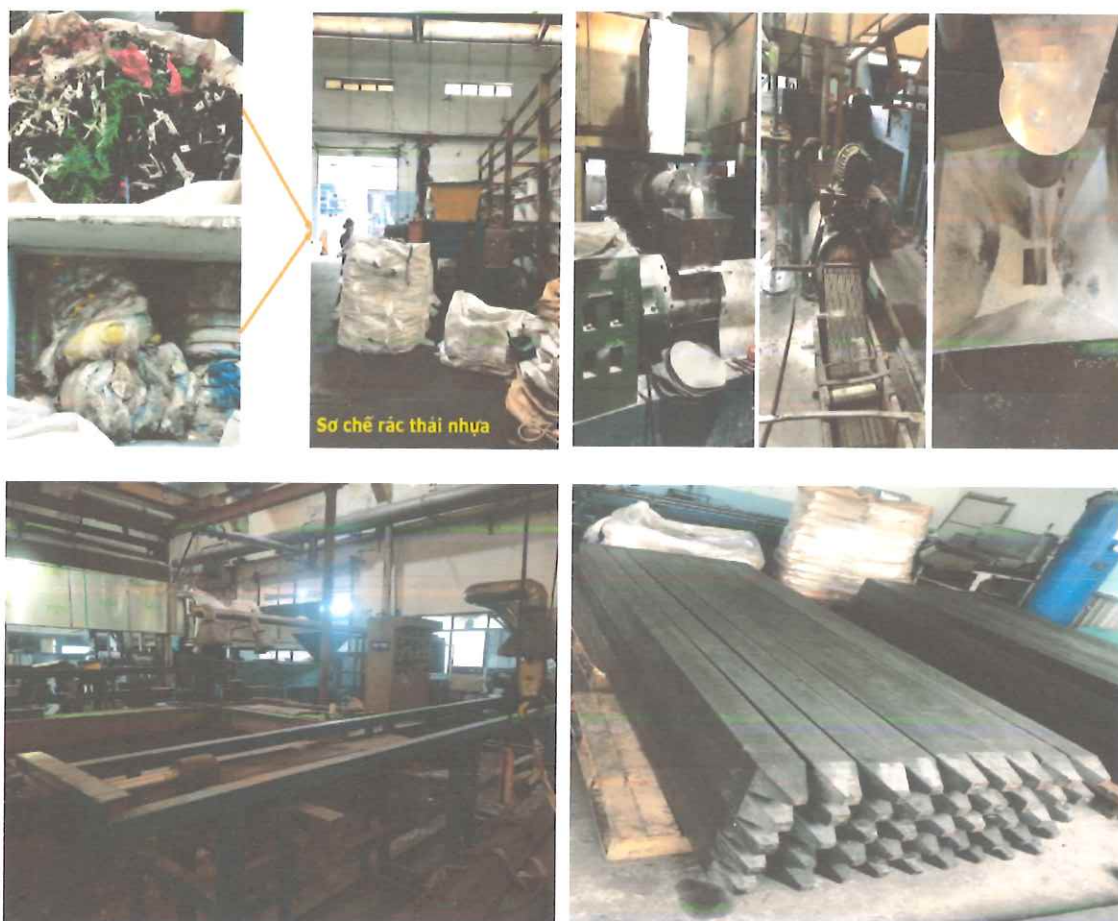
Hình 4. Chế tạo cọc nhựa tại nhà máy Q.M.T-Jp Plastic
