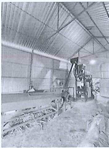
Hình 5a) Băng cấp liệu cho máy thái
