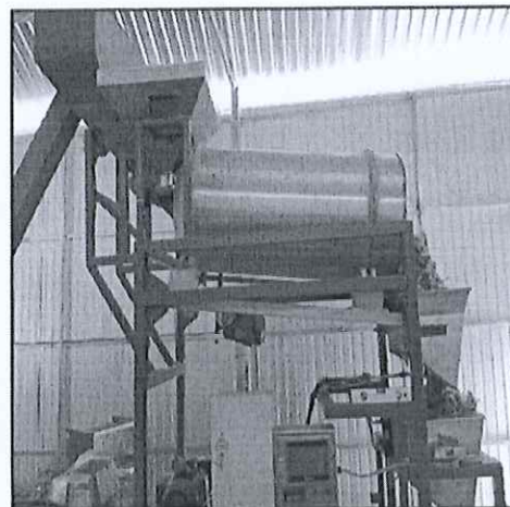
Hình 6b. Máy trộn sau khi chế tạo và được lắp đặt
