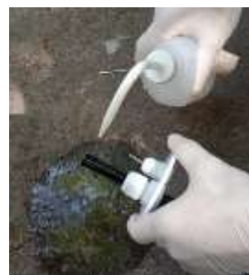
Hình 38. Rửa lại đầu dò bằng nước sạch.
