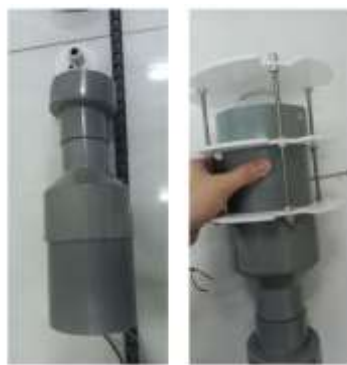
Hình 33. Khoang chứa không khí sau khi lắp ráp.
