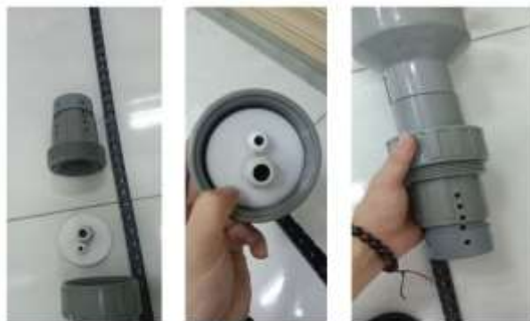
Hình 34. Khoang lấy mẫu đo sau khi lắp ráp.
