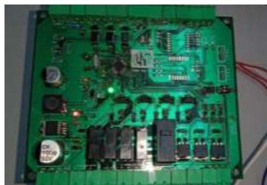
Hình 21. Module điều khiển biến tần cho hệ thống đóng mở cổng tự động thực tế.
