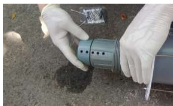
Hình 39. Lắp đầu dò vào lại trong phao cảm biến.
