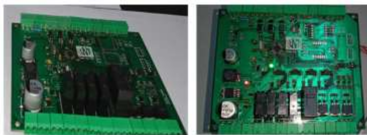
Hình 23. Module giao tiếp với trạm quan trắc độ mặn để nhận lệnh đóng hoặc mở cổng ngăn mặn thực tế.
