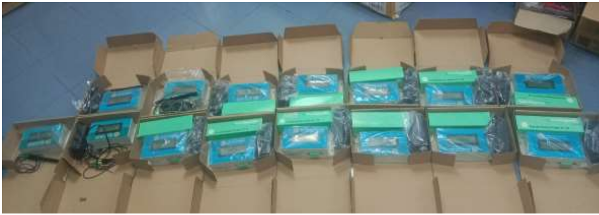
Hình 36. Ảnh chụp 15 bộ đầu dò độ mặn và hộp điện tử để lắp đặt tại các trạm quan trắc ở các cống.
