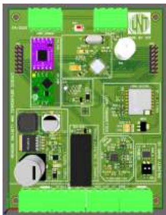
Hình 8. Mạch PCB được thiết kế trên phần mềm Altium.
