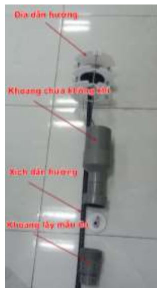
Hình 31. Các thành phần của phao chứa cảm biến quan trắc độ mặn thực tế.
