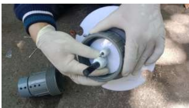
Hình 39. Lắp đầu dò vào lại trong phao cảm biến.
