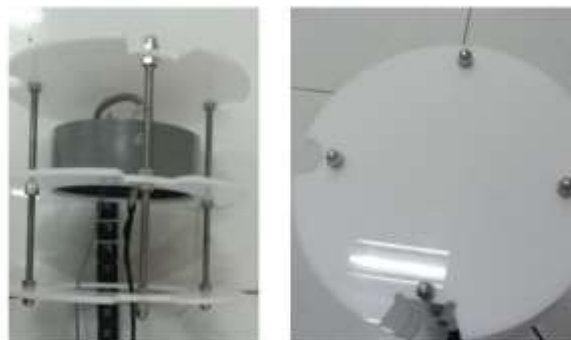
Hình 32. Đĩa dẫn hướng sau khi lắp ráp.
