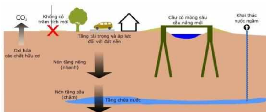
Hình 5.1. Mô phỏng về cơ chế gây nên sụt lún đất
