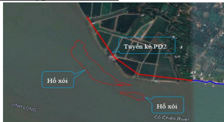
Hình 6.29. Phạm vi hố xói
