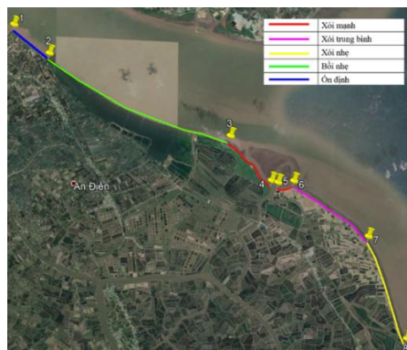
Hình 3.4. Phân loại bờ xói khu vực rạch Vàm Rỗng
