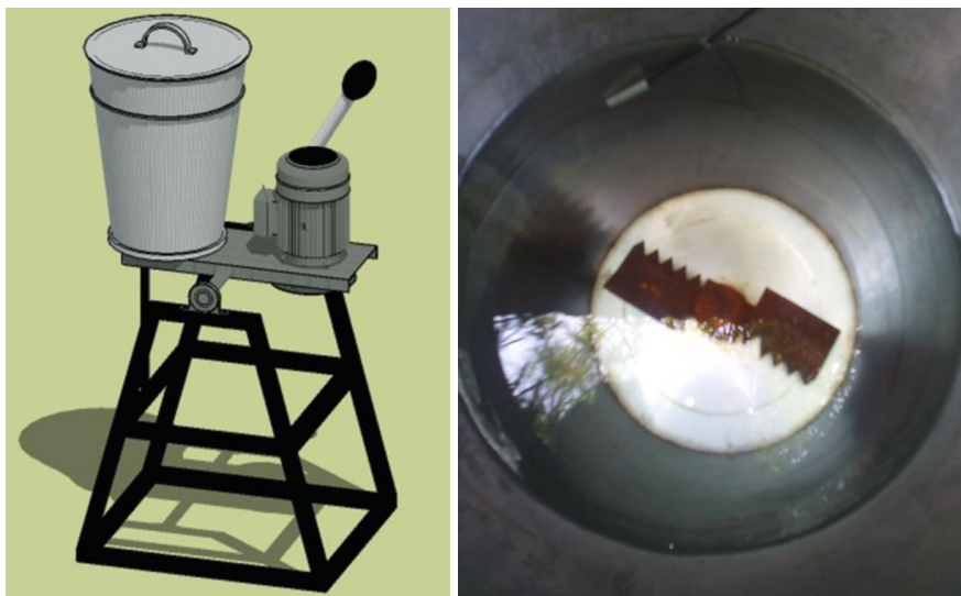
Hình 4.5: Ảnh tổng quan và cấu tạo bên trong thiết bị nghiền thủy lực
