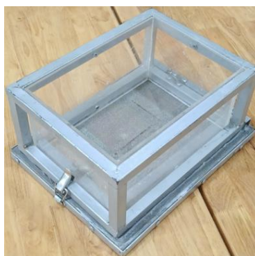
Hình 3.8: Khuôn xeo được sử dụng với thiết lấy khổ giấy A4
