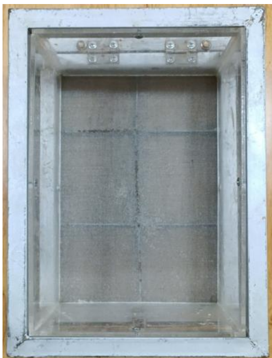
Hình 3.6: Khuôn xeo được sử dụng với thiết lấy khổ giấy A4
