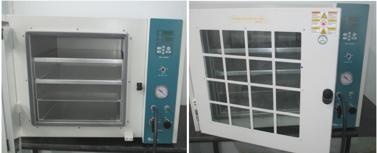
Hình 3.10: Tủ sấy điều chỉnh được nhiệt độ lên đến 300°C
