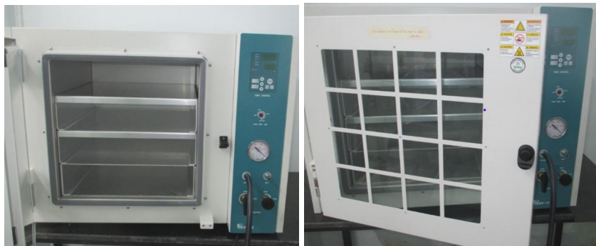
Hình 4.10: Tủ sấy điều chỉnh được nhiệt độ lên đến 300°C
