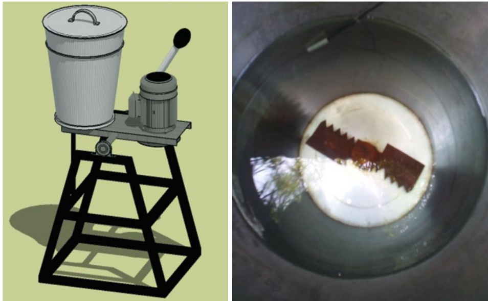
Hình 2.11: Tổng quan và cấu tạo bên trong thiết bị nghiền thủy lực
