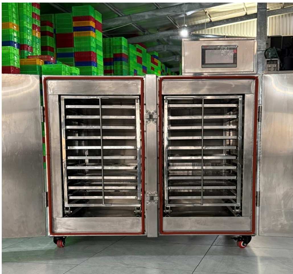
Hình 5.180. Hình ảnh phía trong thiết bị sấy lạnh chuyển giao cho Công ty TNHH Thương mại Cá Việt
