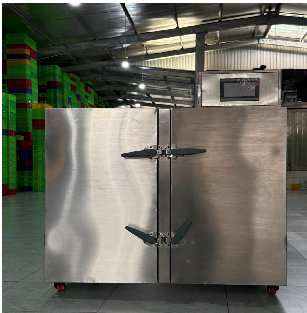
Hình 5.179. Thiết bị sấy lạnh quy mô pilot chuyển giao cho Công ty TNHH Thương mại Cá Việt
