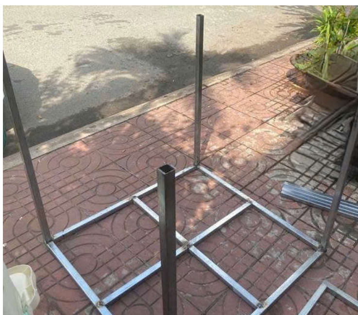
Hình 3 Hàn cắt khung mô hình
