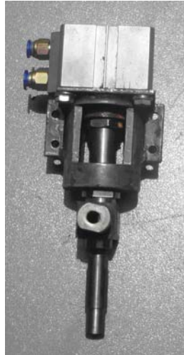
Hình 2.5 :Ảnh van xả khí nén mới chế tạo
