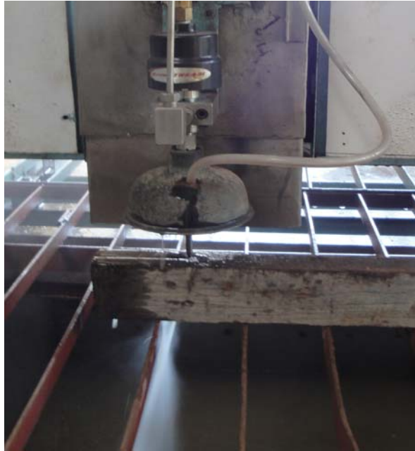
Hình 5.9 Xẻ gỗ dày 15cm bằng tia nước
