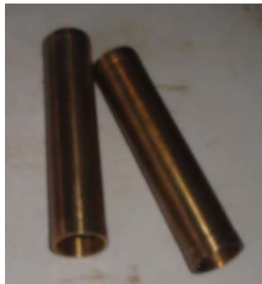
Hình 1.6b :Bạc thân bơm mới chế tạo
