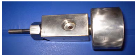
Hình 2.4 :Ảnh van xả lò so mới chế tạo
