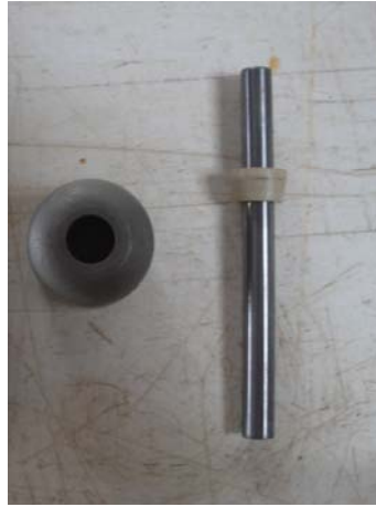
Hình 2.10 : Vòi phun từ Carbit Wonfram mới chế tạo
