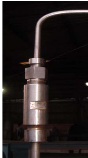
Hình 2.1: Chi tiết co từ ống uốn và cục nối mới chế tạo
