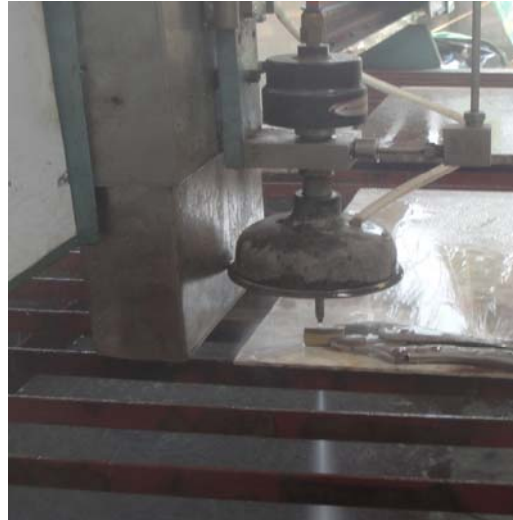
Hình 5.7 Đục lỗ dầu trên bạc thau \Phi 30\text{mm}
