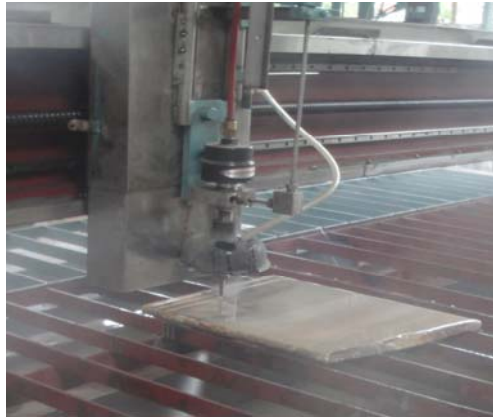
Hình 5.2 : Hình ảnh máy đang cắt đá đỏ dày 20mm
