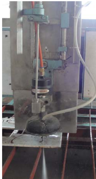
Hình 2.11 :Máy cắt gạch ceramic bằng vòi phun tự chế
