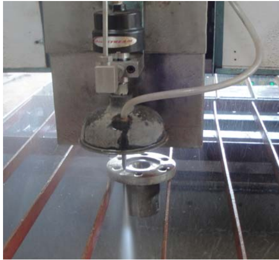
Hình 5.5 Khoan lỗ thép Crom 15mm bằng tia nước
