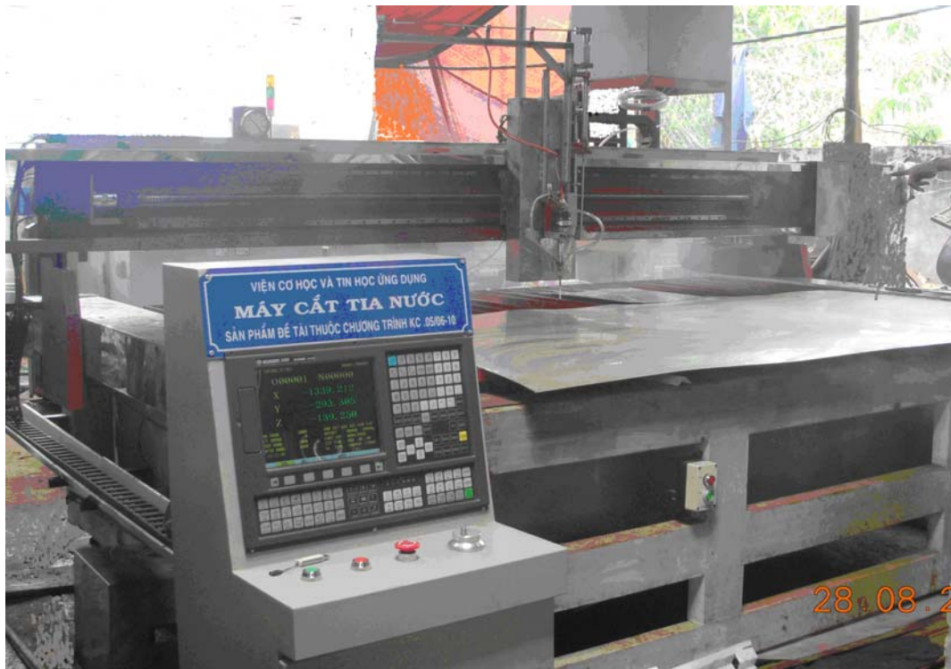
Hình 3.3 Bàn XYZ khi đang cắt thử
