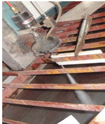
Hình 5.1 Hình ảnh máy đang cắt đá trắng dày 70mm
