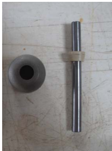
Hình 4 : Vòi phun từ Carbit Wonfram mới chế tạo
