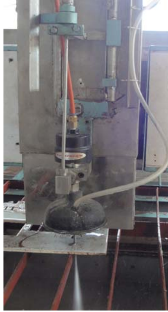
Hình 5 :Máy cắt gạch ceramic bằng vòi phun tự chế
