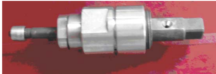
Hình 2.9 Ảnh khớp xoay kiểu FLOW mới chế tạo
