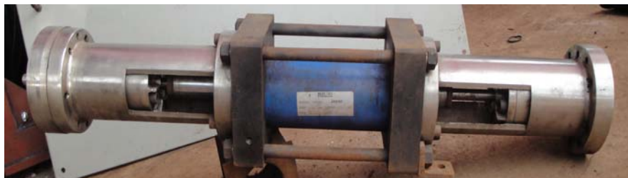
Hình 1.2 Cụm bơm tăng áp kiểu KMT đầu tiên
