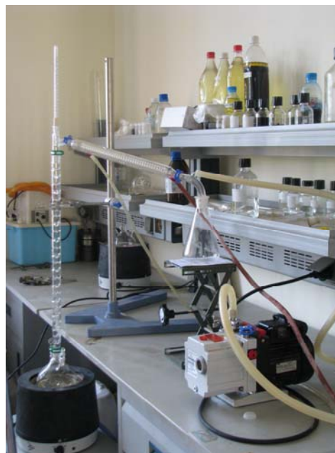
Hình 13: Hệ thiết bị chưng cất chân không qui mô phòng thí nghiệm
