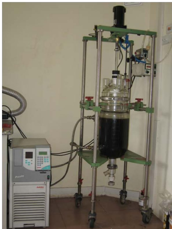
Hình 15: Thiết bị phản ứng qui mô pilot phòng thí nghiệm
