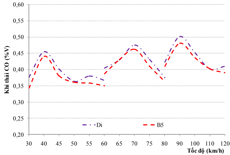
Hình 37 : Kết quả thử nghiệm đối chứng thành phần phát thải CO trên xe Hyundai Porter 1,25T 29X-1016 khi chạy với nhiên liệu Diesel và Biodiesel B5
