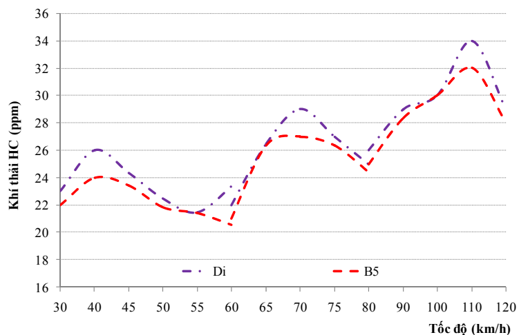
Hình 38 : Kết quả thử nghiệm đối chứng thành phần phát thải HC trên xe Hyundai Porter 1,25T 29X-1016 khi chạy với nhiên liệu Diesel và Biodiesel B5
