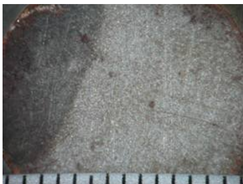
Hình 6.47. Bề mặt Thép cacbon trong \text{NaCl} 3,5% + 5g/L thuốc lá tốc độ dòng chảy 50L/h, 10 ngày thử nghiệm, x25
