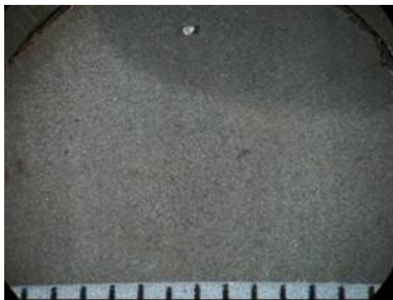
Hình 5.39. Bề mặt Fe trong NaCl 3,5% +10g/L ĐT sau 10 ngày thử nghiệm, x25
