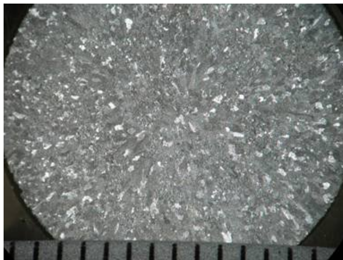
Hình 5.7. Bề mặt Al sau 10 ngày thử nghiệm trong dung dịch HCl 1%+1g/L DT, X25
