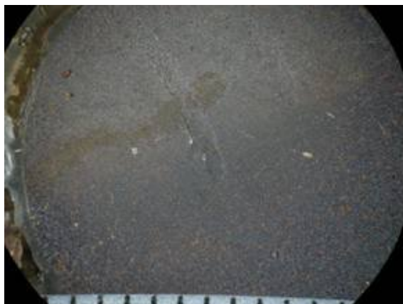
Hình 5.38. Bề mặt Fe trong NaCl 3,5% +5g/L ĐT sau 10 ngày thử nghiệm, x25
