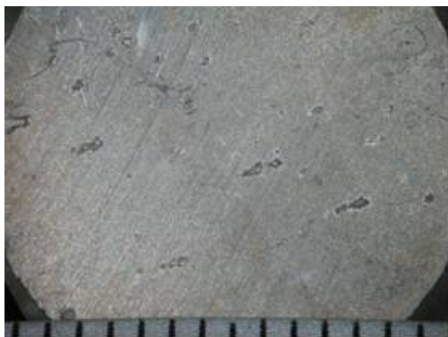
Hình 6.25. Bề mặt nhôm trong \text{NaCl} 3,5%, tốc độ dòng chảy 50L/h sau 10 ngày thử nghiệm, x25
