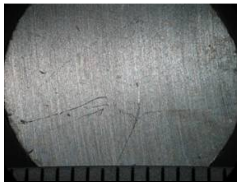
Hình 6.30. Bề mặt nhôm trong \text{NaCl} 3,5% + 5g dấm tương, tốc độ dòng chảy 250L/h, 10 ngày thử nghiệm, x25
