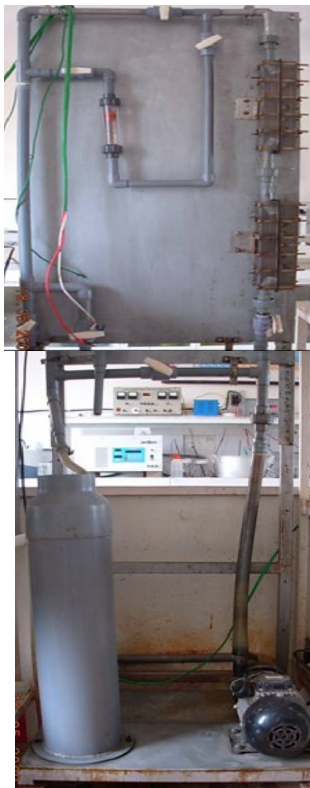
Hình 6.3. Mạch thử nghiệm ăn mòn động
