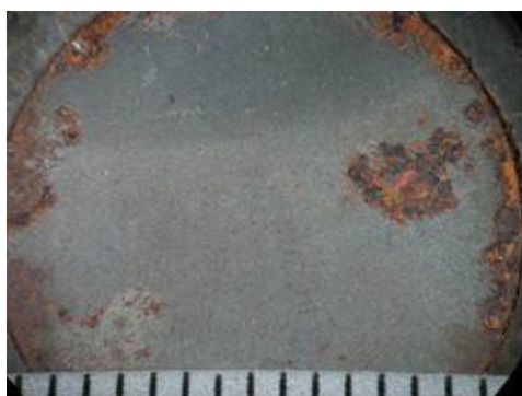
Hình 6.43. Bề mặt Thép cacbon trong HCl 1% + 5g/L Chè xanh tốc độ dòng chảy 50L/h sau 10 ngày thử nghiệm, x25
