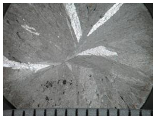
Hình 6.9. Bề mặt nhôm trong HCl 1%, tốc độ dòng chảy 250L/h, 10 ngày thử nghiệm
