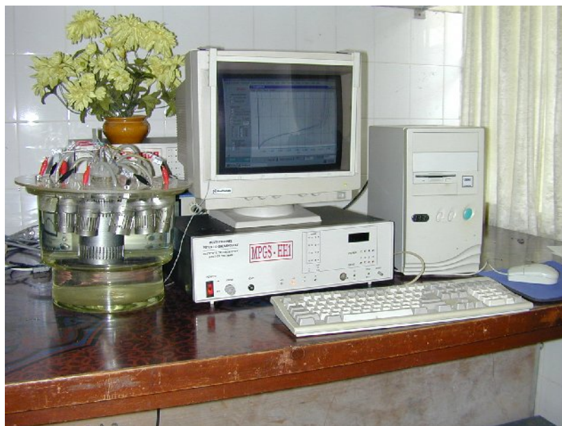
Hình 4.3: Hệ máy đo đa chức năng đa kênh MPGS-HH1 chế tạo tại Phòng ứng dụng Máy tính trong Nghiên cứu Hóa học - Viện Hóa học (Viện Khoa học Tự Công nghệ Việt Nam)
