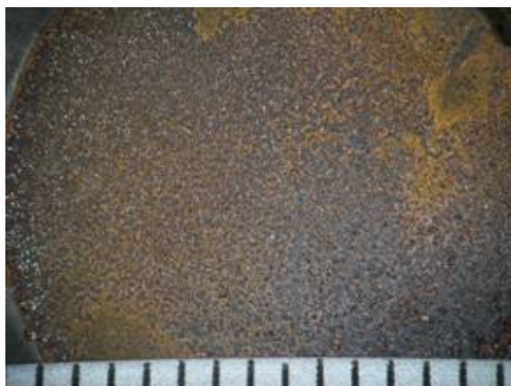
Hình 5.36. Bề mặt Fe trong NaCl 3,5% sau 10 ngày thử nghiệm, x25
