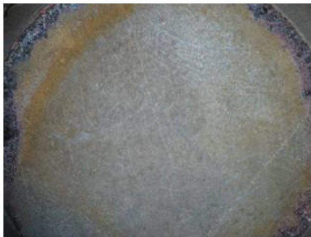
Hình 5.61. Bề mặt thép cacbon sau 10 ngày thử nghiệm trong dung dịch HCl 1% + Chiết suất chè xanh 5g/L, x25
