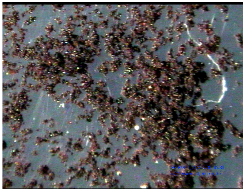
Ảnh chụp LABOMED – 40X: SGS-NT8 dạng hạt kết, chưa được xử lý với axit
