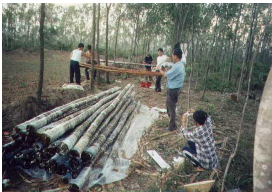
Xử lý bảo quản gỗ bằng \text{XM}_5 dạng cao theo phương pháp khuếch tán
